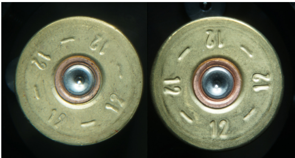
Foto 23 - I due bossoli sperimentali residuati dalle prove di sparo effettuate con il fucile Benelli M2. A sinistra quello contrassegnato con la lettera A, a destra quello contrassegnato con la lettera B.
