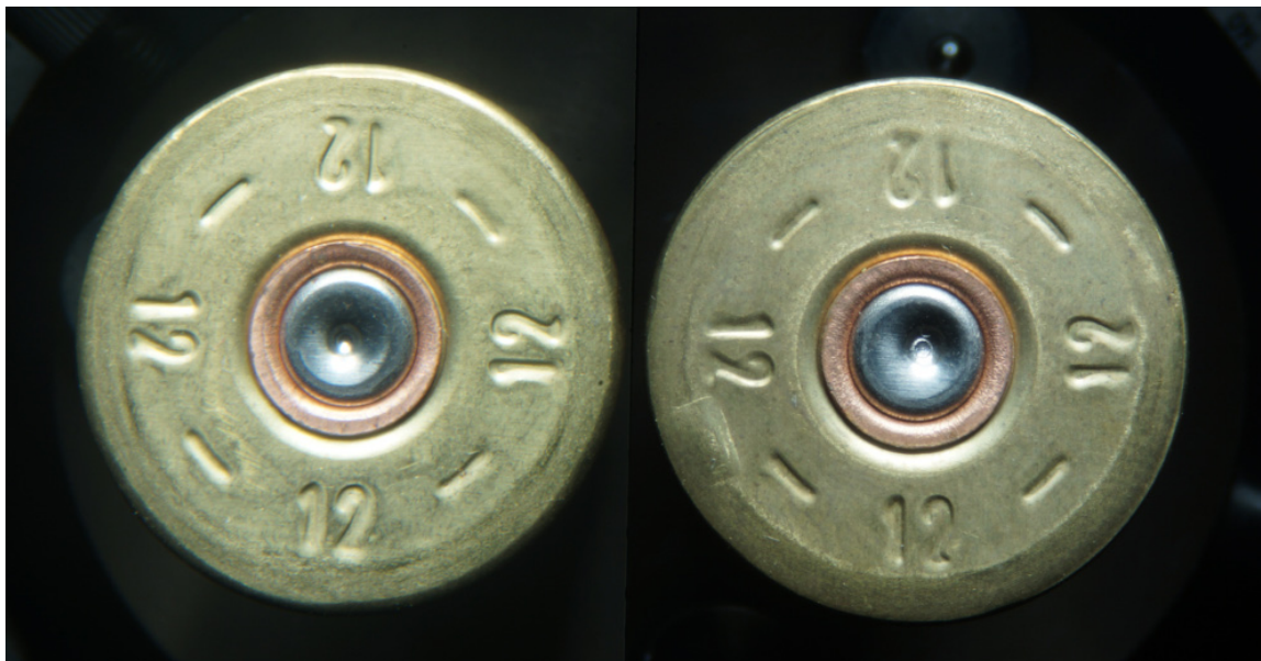
Foto 28 - Il bossolo sperimentale residuo dalla prova di sparo effettuata con il fucile Benelli M2, contrassegnato con la lettera A (a sinistra), visto in accostamento del bossolo C, residuo dalla prova di sparo effettuata con il fucile Beretta A 302 (a destra).
