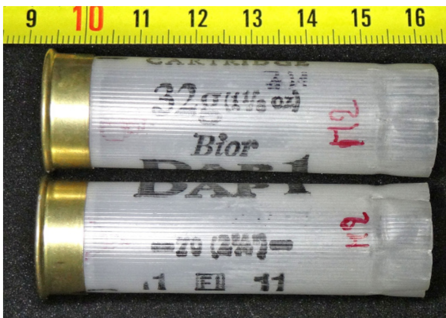
Foto 21 e 22 - I due bossoli residui dalle prove effettuate con fucile Benelli M2 ed il bossolo (a destra) residuo dalla prova effettuata con il Beretta A 302.
