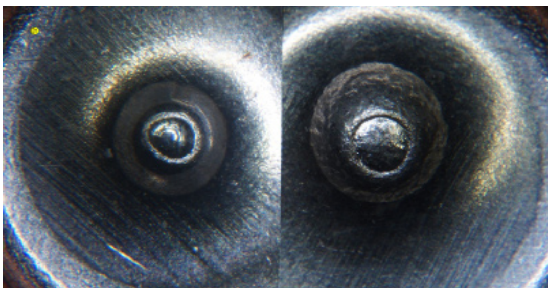
Foto 34 - Visione, in accostamento, delle impronte di percussione dei due bossoli visti nella foto precedente: si nota il differente orientamento delle strie di sottoclasse, e le difformità della base dei due crateri (ciò esclude che l'arma sia la stessa).
