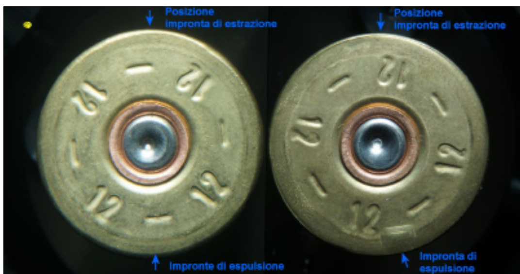
Foto 33 - Visione, in accostamento, del bossolo A residuato dal Benelli M2 (a sinistra), e del bossolo C residuato dal Beretta A 302 (a destra). Gli stessi sono orientati con l'impronta di estrazione ad ore 12: si nota la differente posizione e forma dell'impronta di espulsione (ciò esclude che l'arma sia la stessa).
