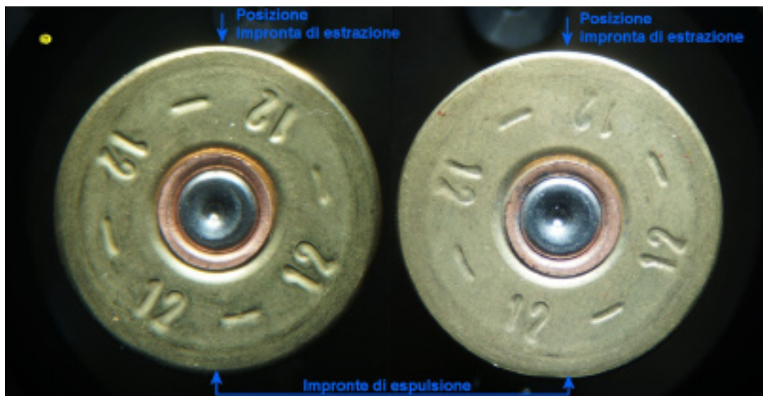
Foto 37 - Visione, in accostamento, del bossolo A (a sinistra) e del bossolo B (a destra), entrambi residuati dal Benelli M2 . Gli stessi sono orientati con l'impronta di estrazione ad ore 12: l'impronta nella medesima posizione.
